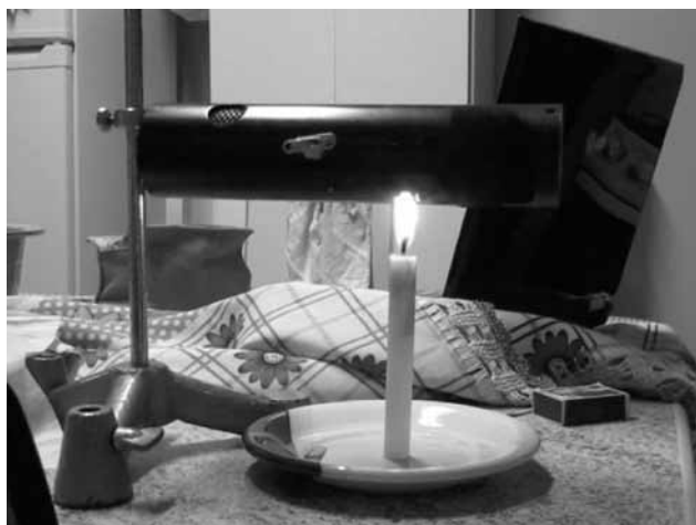
Figura 1. Imagem demonstrativa da transmissão do calor através da barra metálica.
